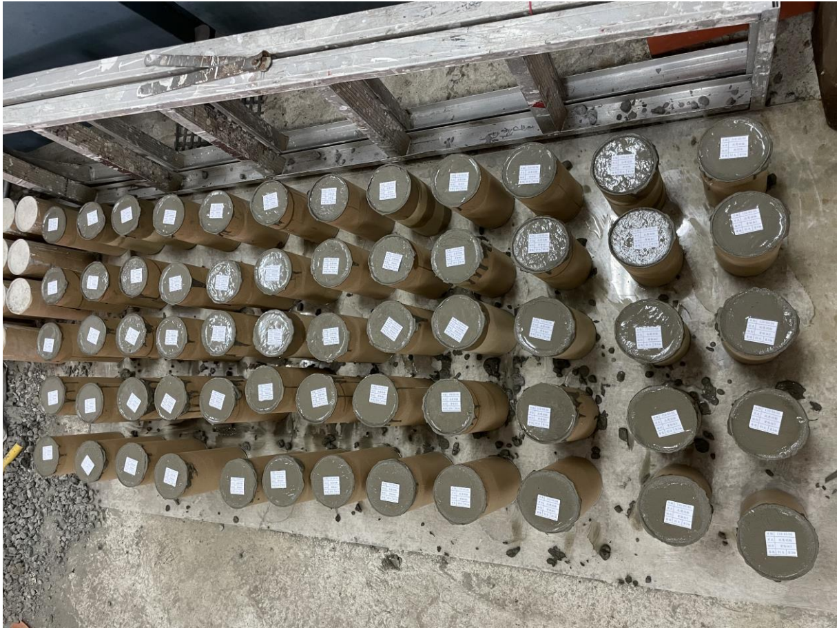
圖 3.11 製作完成之混凝土抗壓試體
